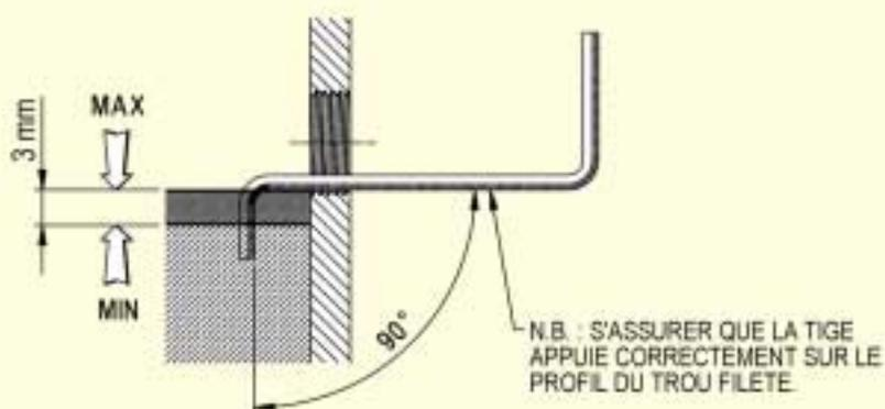
Les réducteurs coaxiaux C11, C21 et C31 (toutes les positions de montage) et orthogonaux A10, A20 et A30 (dans les seules positions B6 et B7) n'ont pas de bouchon de niveau ; dans ce cas, la quantité minimum d'huile doit être contrôlée, contrairement à ce que nous venons de décrire, par un trou pratiqué à cet effet et de la manière décrite ci-dessous.
