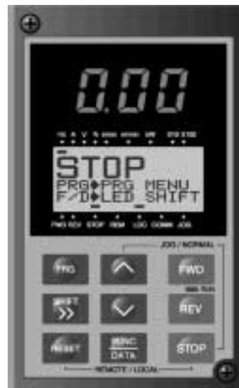
Figure 3-1-2 Affichage sur la micro-console à la mise sous tension
