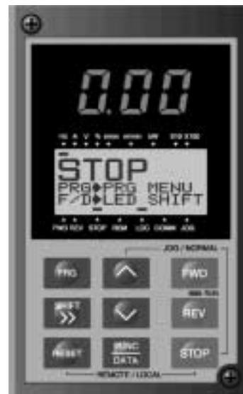
Figura 3-1-2 Display en el teclado al conectar la alimentación
